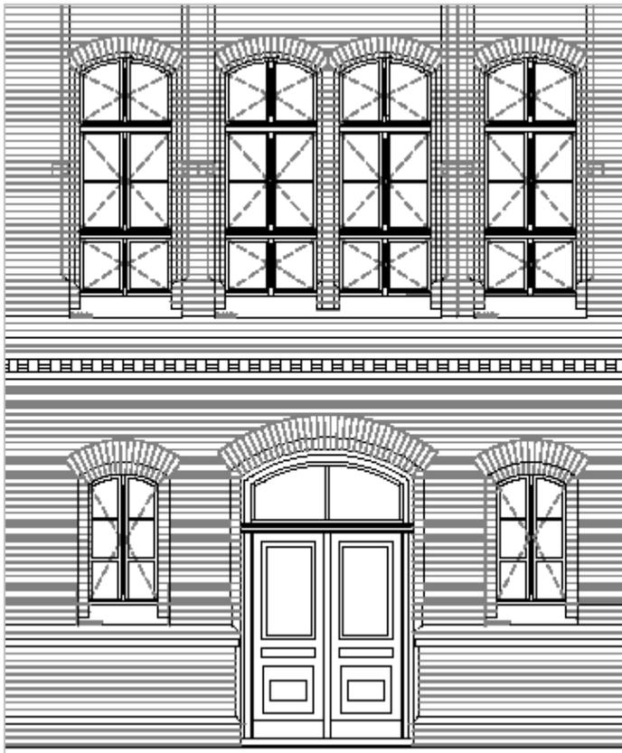
Plan zur Rekonstruktion der durch den Anbau zerstörten Fassade
